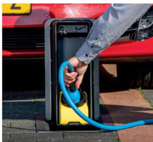
**Hinweis:** Wenn der Deckel des StreetPlug für mehr als 30 Sekunden geöffnet ist, ohne dass das Ladekabel angeschlossen wird, schaltet der StreetPlug für 2,5 Minuten in den Reset-Modus. Schließen Sie den Deckel, die grüne Lampe blinkt nicht mehr. Jetzt ertönt bei Bedienung mit dem Homelink ein kurzer Piepton, aber es geschieht nichts. Der StreetPlug ist nach 2,5 Minuten wieder betriebsbereit.
